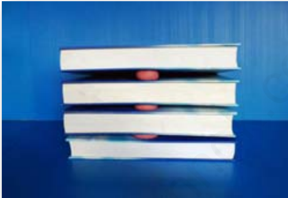
ภาพที่ 11 : การทดลองแรงกดเนื่องจากมวลของวัตถุที่ระดับความสูงต่าง ๆ
